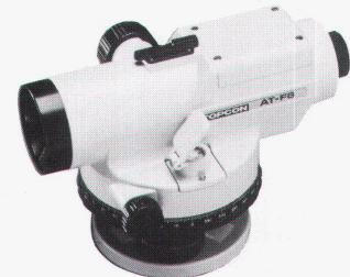
Automatische Nivellierinstrumente TOPCON mit absolut wasserdichtem Fernrohr und sehr stabilem Kompensator, Zielfotoptik, Horizontalkreis 400° oder 360°. Kürzeste Zielweite 0,5 m. Alu-Schiebestativ. Kunststoffbehälter mit Werkzeug, Senklot und Staubhülle.
