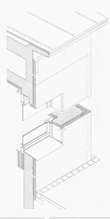
Detailansicht der Fassade mit der neu aufgetragenen Betonschicht / Vue détaillée de la façade après application de la nouvelle couche de béton / Detail view of the façade with the new coating of concrete
