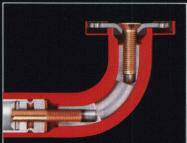
Schnitt durch  $90^{\circ}$  Bogen eines Handlaufs zeigt korrosionsgeschützten Stahlkern und Befestigung.
