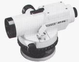
Automatische Nivellierinstrumente TOPCON mit absolut wasserdichtem Fernrohr und sehr stabilem Kompensator, Zieldiopter, Horizontalkreis 400gon oder 360°. Kürzeste Zielweite 0,5 m. Alu-Schiebestativ. Kunststoffbehälter mit Werkzeug, Senklot und Staubhülle.
