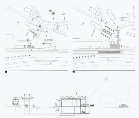
volumen auf der Vorfahrtsebene umschliesst. Die Gebäudehülle ist dabei unter die aussenliegende Stahltragkonstruktion geschoben, was Änderungsund Erweiterungsmöglichkeiten offen lässt. Perronüberdachung und Wartehalle sind nach dem gleichen Grundsatz und bei gleicher Materialwahl konstruiert.
