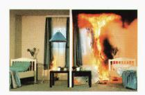
Die Brandversuchsanlage von Hoechst zählt zu den modernsten der Bundesrepublik Deutschland. Im direkten Vergleich wird die flammhemmende Qualität von TREVIRA CS sichtbar.
