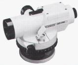
Automatische Nivellierinstrumente TOPCON mit absolut wasserdichtem Fernrohr und sehr stabilem Kompensator, Zieldiopter, Horizontalkreis 400° oder 360°. Kürzeste Zielweite 0,5 m. Alu-Schiebestativ. Kunststoffbehälter mit Werkzeug, Senklot und Staubhülle.
