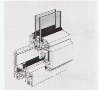
alten Holzfenster. Die flächenversetzten Renaissance-Fenster sind zu fertigen mit einschweisbaren Flügel-sprossen, 60mm breit, mit profilierten Kanten innen und aussen; mit profilierten Ziersprossen, 28 mm breit, für ungeteilte Scheiben; mit klappbaren Ziersprossenrahmen aus kunststoffbeschichtetem Metall.
