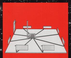
Das ist unser Vorschlag: Von einem zentralen Stockwerkverteiler wird das Heizwasser auf direktem Weg zu den Heizkörpern geführt.
