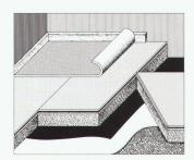
Trockenbodenaufbau mit Trittschalldämmplatte Pavapor Duro auf Betonunterlage
