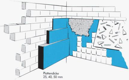
Schlussbeschichtungen: Fertigputz, Dispersionsfarben, keramische Plättli, Tapeten etc.
