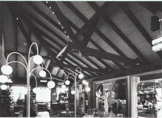
Autobahnrestaurant Mövenpick in Yvorne-Aigle VD:  $1200~\rm m^2$  Schichtex-Spezial  $75/\rm III$ , in Speziallängen, mit Längsfalz und Strukturanstrich, weiss gebrochen, auf Holzpfetten montheten von Strukturanstrich von S
