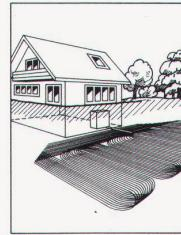
In einem Erdkollektor (in 1 Meter Tiefe verlegte Kunststoffrohre) wird die mittels Sonnenkollektoren gesammelte Energie gespeichert.
