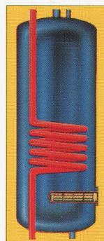
Winterbetrieb: Anschluss an den Heizkessel, da die Raumheizung sowieso läuft. Diese Ausnutzung der vorhandenen Kapazität macht die Energie für die Wassererwärmung extrem günstig. Sommerbetrieb: weil nicht geheizt wird, sorgt der integrierte Elektro-Heizeinsatz für warmes Brauchwasser. Einfaches Schalterdrehen bewirkt die Umstellung von Kessel-Betrieb auf autonomen Boiler-Betrieb.
