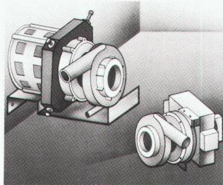
Bauknecht hat den Motor federnd gedämpft in Gummipuffern aufgehängt – wie beim Automotor. Dadurch wirkt das Gehäuse des Geschirrspülers nicht mehr als Tonträger. Und weil gleichzeitig eine 6-Seiten-Rundumisolierung mit dicken, aufgeschmolzenen Bitumenmatten und Mineralwolleisolation Schall schluckt, ist er fast unhörbar.
