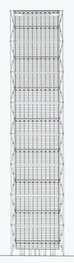
Diagonalen nehmen, dem Höhenabschnitt folgend, nach oben zu erheblich ab, so dass der Kraftfluss in der Struktur auch bei diesem Bau mit punktierter Rohrhülle klar ablesbar ist; durch den Wechsel in grossen Abschnitten von 23 Geschossen wird eine wirtschaftliche Fertigung der Stützenformen und Fenster in grossen Stückzahlen trotzdem möglich. Die Stützenbewehrung ist auch innerhalb der Geschossgruppen in gleichbleibenden Schalformen der nach oben abnehmenden Belastung entsprechend variiert.
