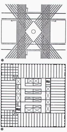
wodurch sich stützenfreie Zonen von 14 bis 18 m Tiefe und eine sehr grosse Flexibilität ergeben, ausserdem wird ein grosser Teil der Vertikalkräfte auf die Aussenwände konzentriert, um die Stabilität der Rohrhaut zu stärken.
