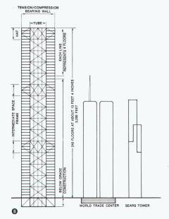
tenlänge technisch möglich sind, liegt nun die Aufgabe in der Entwicklung vergleichbar wirtschaftlicher Stahlbetonkonstruktionen. Nach einer Reihe von Vorstudien entwickelte Hodgkison einen 116geschossigen, 435 m hohen quadratischen Turm mit 66 m Seitenlänge als stehenden Kragarm, bei dem sich ein Verhältnis von 6,5 von Höhe zu Bautiefe ergibt; dies entspricht dem auch in New York beim World Trade Center bei 405 m Höhe und 63 m Bautiefe in Stahlbauweise erreichten Verhältnis.
