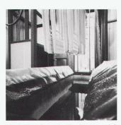
Ein 11000 l fassendes Tauchbecken wird für das Langzeitimprägnieren der Holzteile benötigt.
