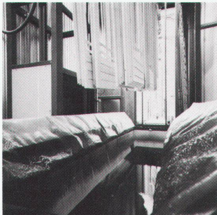
Ein 11000 l fassendes Tauchbecken wird für das Langzeitprägnieren der Holzteile benötigt.
