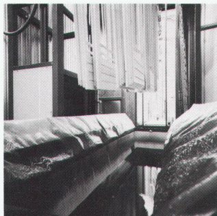
Ein 11000 l fassendes Tauchbecken wird für das Langzeitimprägnieren der Holzteile benötigt.
