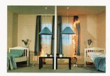
In der Brandversuchsanlage der Hoechst AG können ganze Wohnungsbrände simuliert werden. Im direkten Vergleich werden hier herkömmliche Textilien gegen TREVIRA CS getestet. Zunächst fangen beide Textilien Feuer, TREVIRA CS bereits deutlich geringer.
