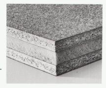
HOMISOL DUO Elemente bestehen aus zwei formaldehydfrei gebundenen Spanplatten und einer druckfesten Kernisolation aus Polyurethan. Sie sind tauchgrundfest hergestellt und lassen sich beliebig beschichten, furnieren oder streichen. Die steglose Verbindung garantiert einen durchgehend gleichmässigen k-Wert.
