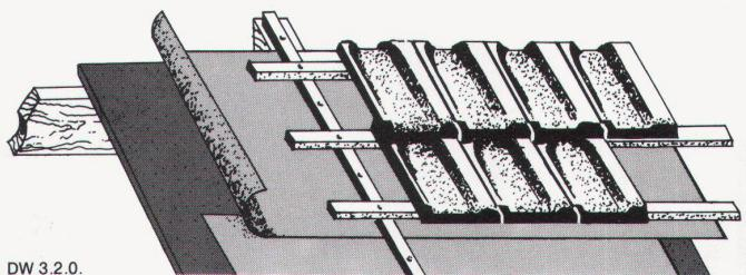
ermöglicht ein fugenloses, wasserundurchlässiges und atmungsaktives Unterdach.
