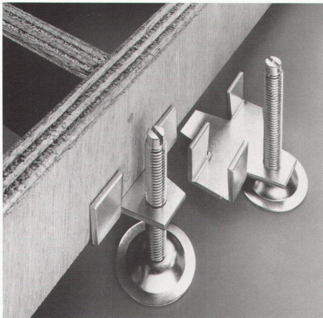
Der Kreuzwinkel Nr. 45.465.01 für die Sockelnivellierung beim Küchenbau. Er wird erst an Ort und Stelle im Bau auf die Sockel aufgesteckt und muss nicht angeschraubt werden. Dadurch lassen sich sämtliche Sockel rasch und mühe los ausrichten. Ihre Arbeit ist noch schneller gemacht.
