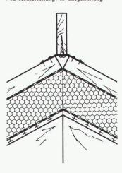
Befestigung des Firstbrettes. Die Verbindungsbügel werden vorgängig im richtigen Abstand der Konterlatten am Firstbrett
