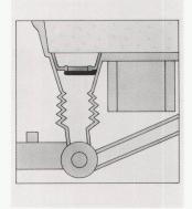
verschluss öffnet sich erst dann, wenn die verschmutzte Lauge abgepumpt werden muss.
