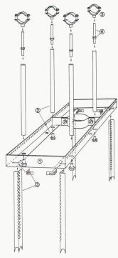
Die Kalt- und Warmwasserzentrale unter dem Schrankboiler
