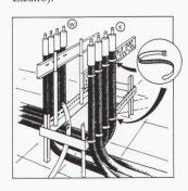
Nach Betonierung, Einbringung des Unterlagsbodens und Aufmauerung der Wände kann die Sanitär-Installation rasch und einfach fertig erstellt werden: Die Warm und Kaltwasser-Verteiler werden mittels Rohrschellen auf die Stützrohre montiert und die VPE-Rohre angeschlos-
