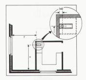
Der Swissnorm-Montagerahmen wird nun auf der Schalung befestigt und dient – in Verbindung mit einer Distanzlehre – als Halterung für alle benötigten VPE-Rohre (Warmwasser, Kaltwasser, Abwasser und Elektro)
