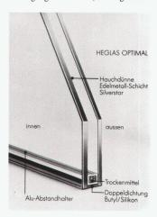
te k-Wert. Je niedriger der k-Wert, desto geringer sind die Wärmeverluste. Heglas Optimal mit Silberbeschichtung hat je nach Typ einen sehr guten k-Wert von 1,6 bis 1,3. Einfachglas dagegen weist einen schlechten k-Wert von 5,8 auf. Normales 2fach-Isolierglas ohne Silberbeschichtung bringt es auf einen mittleren k-Wert von 3,0.
