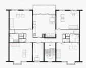
Die türgrossen Aussparungen in den äussersten Tragwänden können zugemauert, offengelassen oder mit einer Türe versehen werden und,
