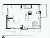
ger durchgehender Raum mit den festen Elementen Treppenhaus, Bad und Toilette kann durch an Deckenschienen befestigte und verschiebbare Trennwände in Wohn- und Schlafzimmer aufgeteilt werden. Dieses Svstem mobiler Raumunterteilung erlaubt auch Zwischenlösungen, indem durch teilweises Öffnen und Schliessen vielschichtige Raumbezüge und -nutzungen möglich werden."
