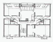
Die variablen Elemente, nichttragende Zwischenwände, verschiedene typisierte Bauteile für die Aussparungen und Ausstattung werden nach Bedarf beigefügt (gestrichelt angegeben).
