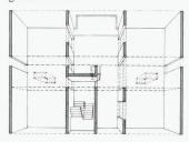
Tragstruktur, Trennwände zwischen Aufenthalts- und Verkehrsräumen, Nasszellen, Installationsund Treppenhauskerne bilden die fixen Elemente der künftigen Grundrisse.
