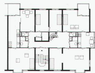
5, 6 Die türgrossen Aussparungen in den äussersten Tragwänden können zugemauert, offengelassen oder mit einer Tür versehen werden, und,
