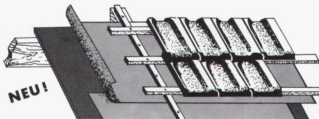
ermöglicht ein fugenloses, wasserundichtes, dampfdurchlässiges und atmungsaktives Unterdach.
