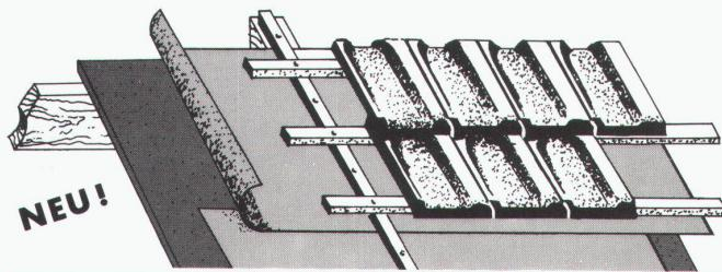
ermöglicht ein fugenloses, wasserdichtes, dampfdurchlässiges und atmungsaktives Unterdach.
