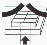
Das heisst: Eigentlich wollten wir Ihnen mitteilen, dass dieses Problem keines mehr ist. Denn mit Geilinger-Pilzen wird die Beanspruchung im Auflagebereich ganz entscheidend verringert: Die Durchstanzfläche wird vergrössert, die Schubspannungen werden herabgesetzt. Und spezielle Armierungen erübrigen sich.
