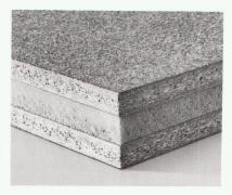
HOMISOL DUO Elemente bestehen aus zwei formaldehydfrei gebundenen Spanplatten und einer druckfesten Kernisolation aus Polyurethan. Sie sind tauchgrundfest hergestellt und lassen sich beliebig beschichten, furnieren oder streichen. Die steglose Verbindung garantiert einen durchgehend gleichmässigen k-Wert.
