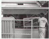
Auf eine fachgerechte Oberflächenbehandlung wird bei Piatti-Fenstern ganz besonderer Wert gelegt. Im Unterschied zu herkömmlichen Techniken werden Rahmen und Flügel bei Piatti vollständig und ohne Beschläge langzeitgetaucht. So kann die Grundierung tiefer und intensiver in das Holz eindringen. Der Schutz vor Verwitterung, Verschmutzung und Feuchtigkeit ist damit optimal garantiert.
