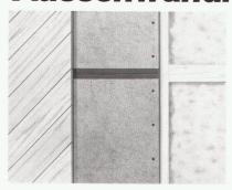
PAVATEX-ISOLAIR-Baustoffe sind Holzfaserplatten mit einem Bitumengehalt von ca. 15%. Frei von teerhaltigen Derivaten stellen die atmungsaktiven Platten eine baubiologisch wertvolle Lösung dar. Leichte, grossflächige Formate ermöglichen eine wirtschaftliche und rationelle Verarbeitung. Verlangen Sie ausführliche Unterlagen über den Einsatz von PAVATEX-ISOLAIR-Platten. Rufen Sie uns an: 042/365566.
