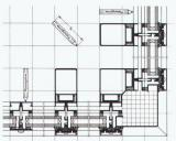
Schnittdetails, Einbaubeispiele für Fenster, Türen und Lüftungsflügel. Spezielle Kapitel sind der Lüftung, dem Sonnenschutz und der Verglasung gewidmet. Das Sunray-Profilsystem mit doppelter Wärmedämmung, kontrollierter Wasserableitung und extrem schlanker Profilierung hat sich innert kurzer Zeit am Markt durchgesetzt.
