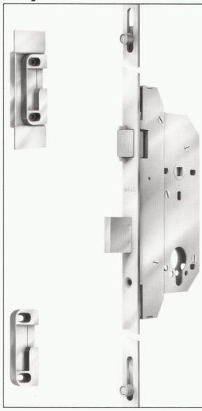
Treplane von Glutz schliesst dreifach. Neben einem Riegel aus gehärtetem Stahl, greifen oben und unten je ein Rollzapfen in die Zarge. Ein durchgehender einteiliger Stulp gibt zusätzliche Festigkeit. Aber auch mehr Stabilität gegen ein Verziehen des Türblattes.
