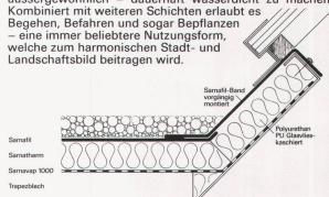
Anschluss der Sarnafil-Bedachung an Shedaufbauten.
