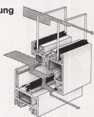
praktisch eine ganze Schallschutzklasse höher liegen. Besonders Kunststoff-Doppelverglasungsfenster kombinieren in einfachster Weise ohne teure Sondergläser guten Wärmeschutz mit höchstem Schallschutz. (EMPA-geprüft).
