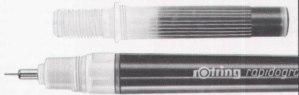
Der rotring rapidograph ist heute unser wartungsfreundlichster Tuschefüller. Weil er mit einer Kapillarpatrone bestückt wird: Tuscherpatrone und Tuschenwendel sind hier aus einem Guss. Somit erhält der rotring rapidograph bei jeder Nachfüllung automatisch auch ein neues, frisches Druckausgleichssystem.
