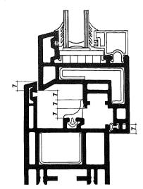
7mm Auflage und bietet eine getrennte Regen- und Windsperre. Sie ist dauerhaft elastisch und haltbar, gegen mutwilliges Herausreissen gesichert und leicht auszuwechseln.
