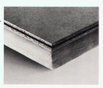
HOMISOL-Dämmelemente bestehen aus einer Spanplatte und einer Isolationsschicht aus Polyurethan oder Glaswolle. Die HOMOGEN-Deckplatten sind in den Qualitäten STANDARD, ISO V100 (Feuchteschutz) oder IG V100 (Brandschutz) erhältlich. Die Nut- und Feder-Verbindung sorgt immer für fugendichte Flächen.
