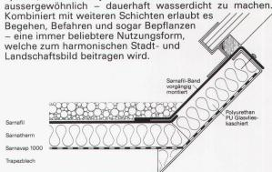
Anschluss der Sarnafil-Bedachung an Shedaufbauten.
