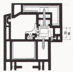
Die Brügmann-Fensterprofile sind so ausgebildet, dass handelsübliche Beschläge bezüglich Befestigung und Bauphysik richtig eingebaut werden können. Das Kammermass beträgt 13 mm und gewährleistet somit, daß eine einwandfreie und dauerhafte Funktion der Beschläge gegeben ist.
