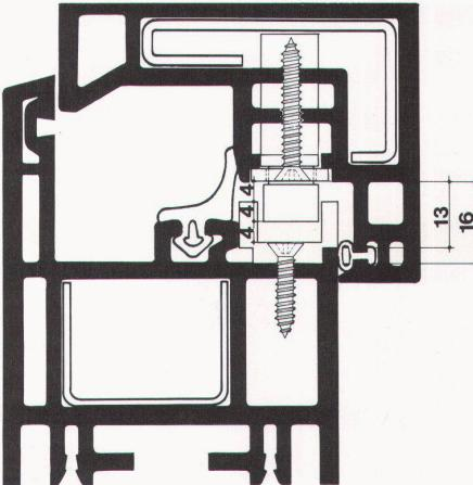
Die Brügmann-Fensterprofile sind so ausgebildet, dass handelsübliche Beschläge bezüglich Befestigung und Bauphysik richtig eingebaut werden können. Das Kammermaß beträgt 13 mm und gewährleistet somit, daß eine einwandfreie und dauerhafte Funktion der Beschläge gegeben ist.
