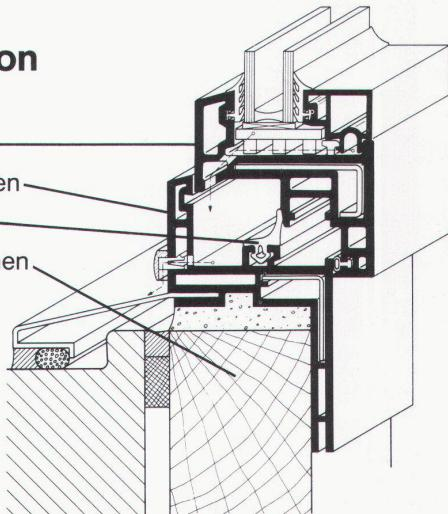
**Brügmann Kunststoff-Fenster-Systeme bieten mit dem Wechselrahmenfenster auch für die Renovation viele Lösungsmöglichkeiten.**
