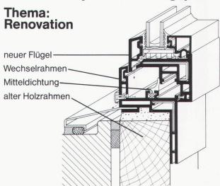
Brügmann Kunststoff-Fenster-Systeme bieten mit dem Wechselrahmenfenster auch für die Renovation viele Lösungsmöglichkeiten.
