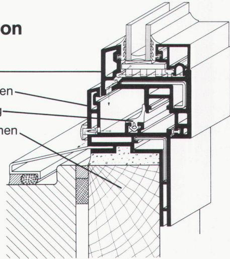
Brügmann Kunststoff-Fenster-Systeme bieten mit dem Wechselrahmenfenster auch für die Renovation viele Lösungsmöglichkeiten.
