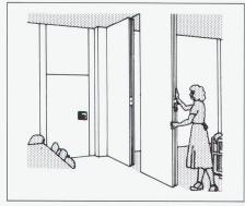
Hüppe Variflex ist ein bewegliches, in Deckenschienen laufendes Trennwand-System. Wartungsfreiheit, hervorragende Schalldämmung und eine Vielzahl an Oberflächenvarianten machen Variflex zum idealen und universellen Trennelement für Schulen, Mehrzweckhallen, Kulturzentren, Gaststätten und Hotels.
