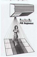
Technische Daten: 10–24 V AC, 12–36 V DC, 220 V AC. Relaisoder kurzschlussfester Elektronikausgang. Reichweite: frontal und seitlich exakt einstellbar. Für Tür und Tor bei 2,5 m Montagehöhe: 1,8 m frontal, 2,6 m seitlich. Raumüberwachung: 10 m frontal (je 6 Strahlen in 3 Ebenen).
