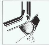
Fallbeispiele für die Schallisolation von Rohren mit Geberit-Isol. Für die Rohrdimension 110 mm gibt es vorgestanzte Teile, die im Handumdrehen montiert werden. Das bedeutet Geld- und Zeiter-
