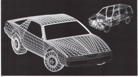
Übertragung der einzelnen Karosserieschnitte auf ein Polystyrol-Grundmodell, an dem der  $C_w$ -Wert im Windkanal überprüft werden kann / Report des différentes coupes d'une carrosserie sur une maquette en polystyrène expansé permettant l'étude du coefficient  $C_w$  en soufflerie / Transfer of the car body sections to a basic model of polystyrol, making a testing of the  $C_w$ -rate in a wind tunnel possible
