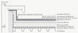
Schichtaufbau eines Sarnafil-Flachdaches auf Profilblechen
