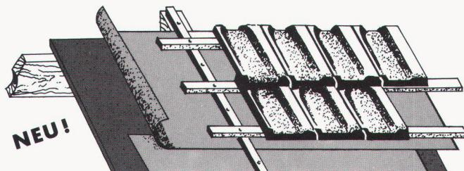
ermöglicht ein fugenloses, wasserdichtes, dampfdurchlässiges und atmungsaktives Unterdach.
