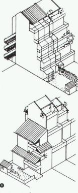
hausbüro SMÅA (Stockholms Kommun genom Småstugeavdelningen) entwickelte Olle Volny ein mehrgeschossiges Selbstbausystem für rund 300 Wohnungen, das auf einem «Baukasten» für selbstbaubare Haustypen innerhalb eines Modulsystems beruht und sich durch Flexibilität und spätere Umwandlungsmöglichkeiten auszeichnet.
