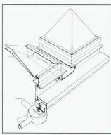
2. GS-System (Gutter-Skylyte) für Rinnen-Lichtdach-Konstruktionen
