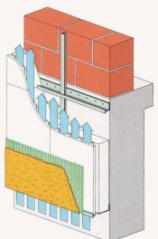
Auf dem Mauerwerk werden mittels Trägerschienen STO-Wärmedämmplatten mit vertikaler Hinterlüftung als thermische Isolation montiert. Durch diese Hinterlüftung wird allfällig auftretender Wasserdampf problemlos an die Aussenluft abgegben. Und aussen wird die Fassade im traditionellen Stil verputzt. Mit einem Verputz-System, das wir von Stotmeister in diversen Strukturen, Körnungen und Farben in unserem Werk in Niederglatt/ZH herstellen.
