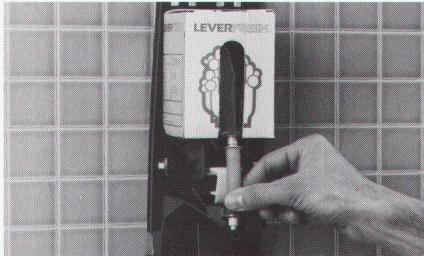
**3 einsetzen** in den Seifenspender. Damit ist gleichzeitig die Dosiervorrichtung in Betrieb.
