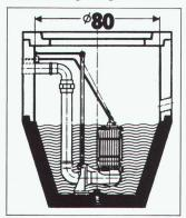
Die Abwasserpumpe Typ 2420 stellt eine Weiterentwicklung der bewährten Häny-Tauchmotorpumpen dar. Der ölgefüllte Motor mit dem Abdichtungssystem aus zwei unabhängigen Gleitringdichtungen wurde weitgehend unverändert übernommen, während der hydraulische Teil, basierend auf dem verstopfungsfreien Wirbelrad, den neuen Anforderungen entsprechend gestaltet wurde. Mehr als hundert solcher Pumpen haben sich bereits im täglichen Einsatz bewährt. Die Pumpe ist an einem Kupplungsfuss im Schacht
