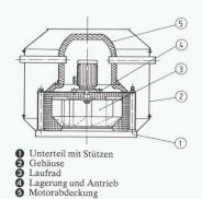
bestehen die Ventilatoren aus einem zylindrischen Gehäuse, in das ein Radialläufer mit einem darüberliegenden Motor eingebaut ist. Der Motor und die elektrische Zuleitung sind gegen den Gasstrom abgekapselt. In diese Kapselung wird bei Betrieb ständig von aussen durch zwei Rohre Umgebungsluft eingesaugt, durch einen ringförmigen Spalt vom Läufer abgesaugt und mit dem Brandgasstrom zusammengeführt. Auf diese Weise ist eine ständige Kühlluftzufuhr zum Motor sichergestellt.
