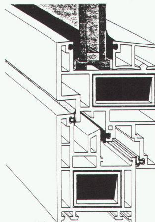
Der Sarnapane-Profilquerschnitt Formstabiler Markenkunststoff Verwindungssteife Mehrkammerprofile Optimale Glasfalbelüftung und -entwässerung über Vorkammern Bis zu 3 Dichtungen auswitterungsbeständigem, hochrückstelfähigem APTK Korrosionsgeschützte Verstärkungen (so weit notwendig) von Flügel- und Blendrahmen
