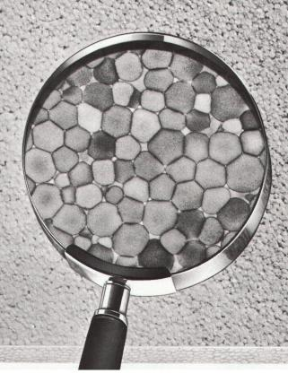
1 m³ Polystyrol-Hartschaum besteht aus rund 3-6 Milliarden mikroskopisch kleinen luftgefüllten Zellen. Darauf beruhen die hervorragende Wärme-Dämmfähigkeit und die hohe Druckfestigkeit von Polystyrol-Hartschaum. Das leichte Eigengewicht und die vielen anderen vorzüglichen Eigenschaften machen Polystyrol-Hartschaum zum idealen Isoliermaterial
