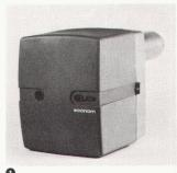
Öl-Vermischung erzielt und anderseits mit einer elektronisch regulierten Düsenstangenheizung das Öl auf ca. 80°C vorerwärmt. Die Luft-/Öl-Vermischung wird dadurch nochmals verbessert. Als Nebeneffekt wird zudem das Ölvolumen vergrössert und der Einsatz einer entsprechend grösseren Düse ermöglicht. Damit konnte auch die Verstopfungsgefahr der sonst notwendigen Kleindüse eliminiert werden.
